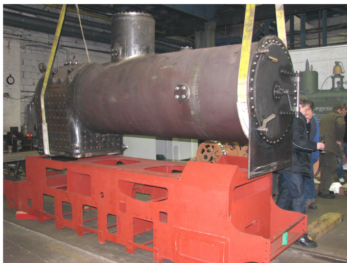
Die „Hochzeit“ von Kessel und Rahmen
