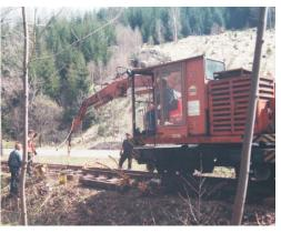
Seit 2000 liegt das Haupteinsatzfeld für den gleisgebundenen Bagger bei der Streckenunterhaltung, bei Ladearbeiten und der Beräumung von Bahngräben und Material entlang der Strecke. Aber er wird auch schon mal als mobiles Hebezeug für die Bauteilmontage für die Fahrzeuginstandsetzung durch die Werkstatt eingesetzt.
